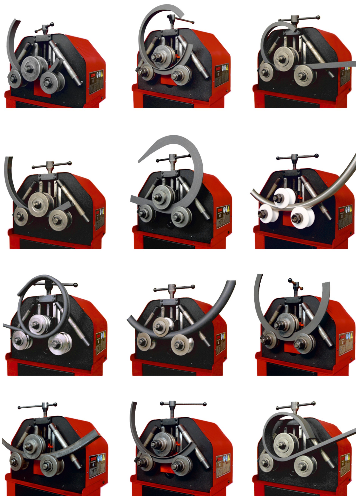
Illustration 13. Exemples de cintrage avec différents tubes et profils
