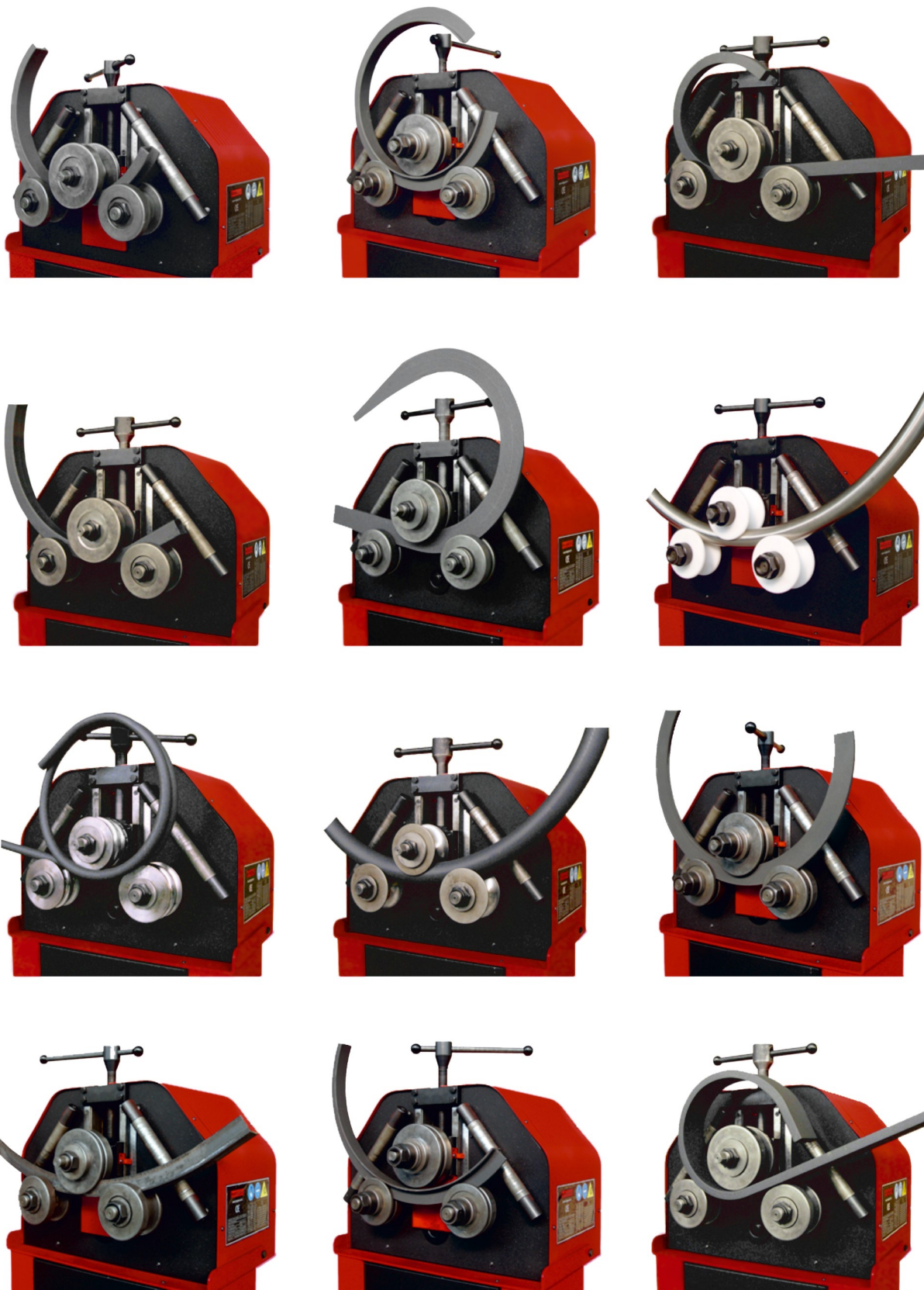
Illustration 14. Exemples de cintrage avec différents tubes et profils
